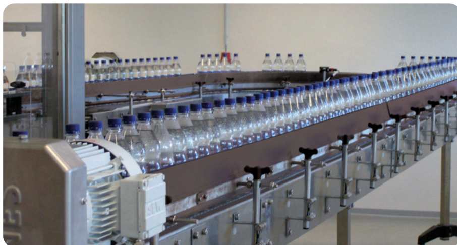
Fördersystem mit Gleitelementen aus LubX® S und LubX® C Conveyor system with sliding parts from LubX® S and LubX® C
