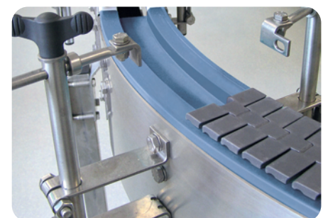
POM Transportkette auf LubX® C POM transport chain on LubX® C
